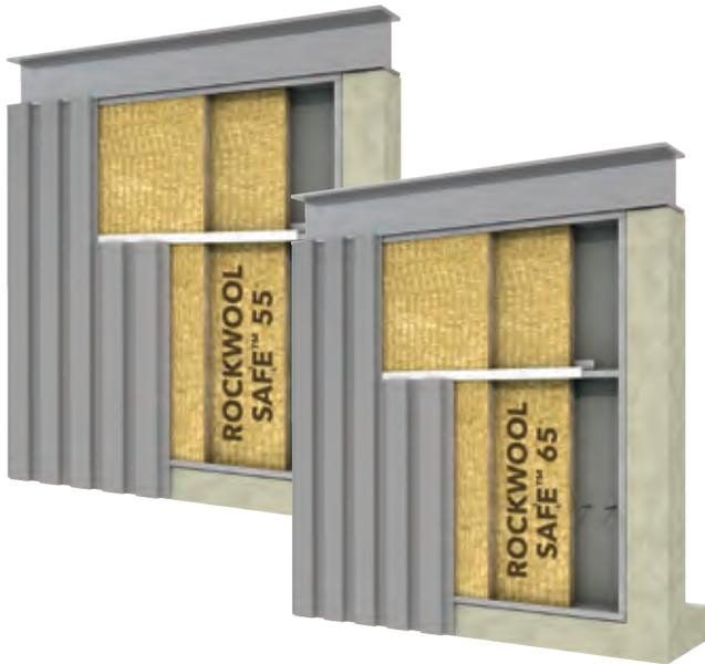
Componentes: Revestimiento exterior metálico, ROXUL SAFE™ 55 & 65, Perfiles de lámina de acero en zeta, colchoneta cerámica contra incendio (cobertura de perfiles en zeta), Perfiles tapajuntas, Revestimientos / Accesorios de muro y divisiones.
